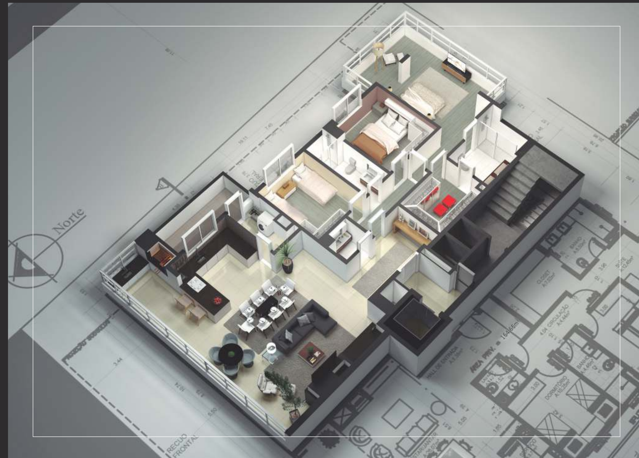
Orientação solar impecável. Fachada Norte com aberturas. Dormitórios Leste e Oeste (maior circulação de vento e insolação)
